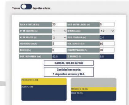
La aplicación dispone de un **asistente de preparación de caldo** que informa sobre: la mezcla a preparar, el caudal por boquilla, distancia, tiempo de aplicación...
