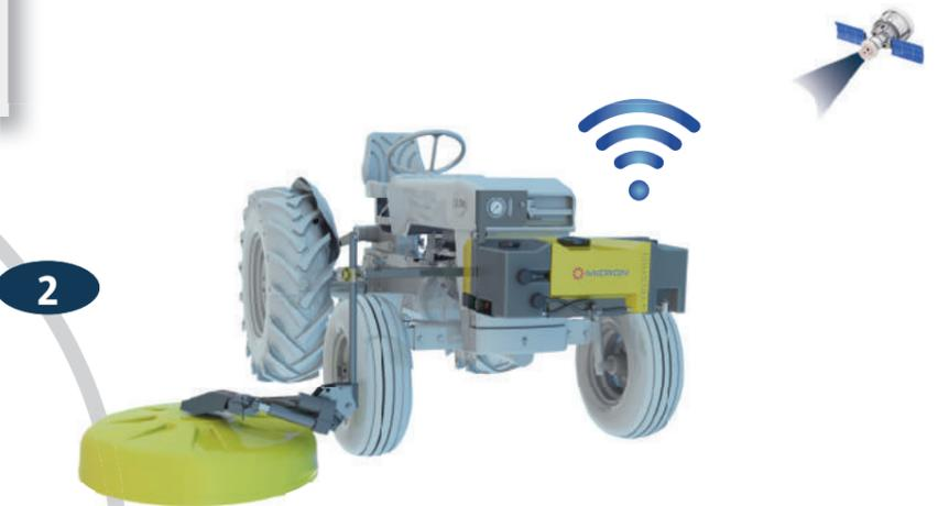
El software se comunica con el pulverizador y el agricultor en tiempo real, controlando la posición, velocidad y otros parámetros de funcionamiento del equipo. El agricultor puede visualizar el trabajo durante la aplicación y recibir alertas para corregir las desviaciones. Esto garantiza una pulverización de precisión.
