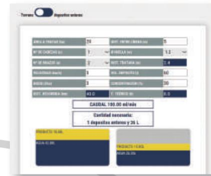
L'application dispose d'un assistant de préparation du liquide qui donne des informations sur : le mélange à préparer, le débit par buse, la distance, le temps d'application...
