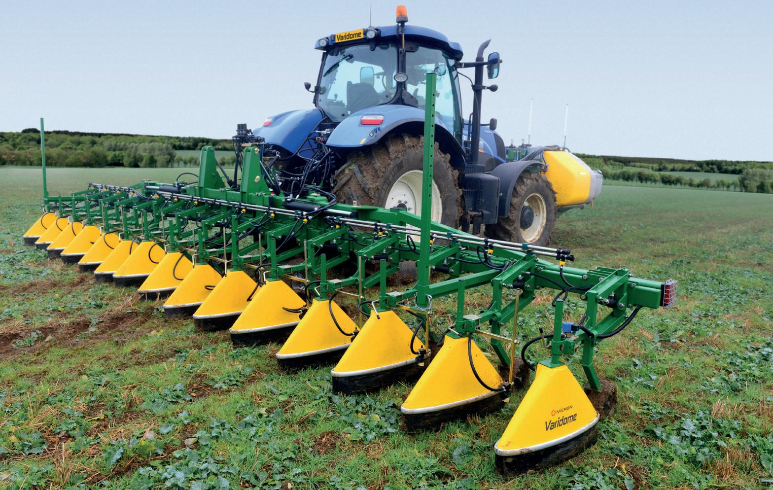
Utilizando tecnologia inovadora de aplicação, Varidome consiste em uma série de aplicadores de baixo volume em banda projetados para remover com segurança ervas daninhas entre as linhas de cultivo. Os pulverizadores também estão disponíveis com o Sistema Dual Spray de Micron, que permite a aplicação simultânea de mais um produto na linha de cultivo.
